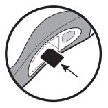
La DDC est partiellement éjectée et peut être retirée en la tirant hors du logement. Pour installer une nouvelle DDC, insérer la DDC, étiquette vers le haut, dans la fente mince ménagée sur le dessus du logement de l'ensemble batteries. La carte doit s'enclencher et ne doit pas dépasser du logement. Si la carte ne peut être enfoncée complètement, cela peut signifier qu'elle a été introduite à l'envers. Dans ce cas, retirer la carte, la retourner et essayer de l'introduire à nouveau.
