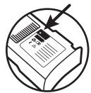
L'indicateur d'état opérationnel de l'ensemble batteries se trouve sur le côté étiquette de l'ensemble batteries et est utilisé pour indiquer l'état de l'ensemble batteries. Une DEL verte clignotant à intervalles réguliers indique que l'état de l'ensemble batteries est bon et que l'ensemble batteries est prêt à l'emploi. L'absence de DEL verte clignotante indique un problème au niveau de l'ensemble batteries, ou la décharge ou
